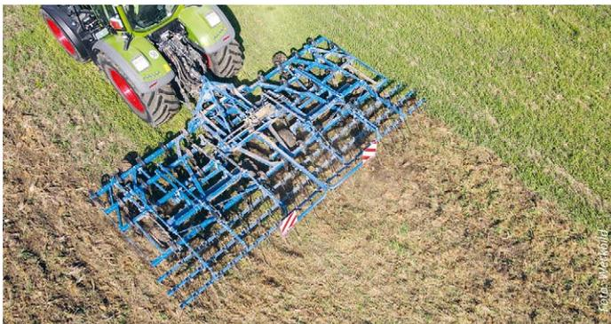
der Fläche optimal erfassen können. Die Einstellung der Arbeitstiefe erfolgt hydraulisch vom Schlepper aus und kann stufenlos während der Arbeit angepasst werden. Auch die Einstellung des Nach-
