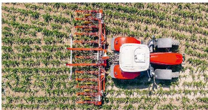
Das Konzept des Flexcare-Hackgeräts von Pöttinger bietet volle Flexibilität für den Einsatz in unterschiedlichen Kulturen. Passend zum gegebenen Reihenabstand kann die Arbeitsbreite der Hackelemente, die richtige Position
