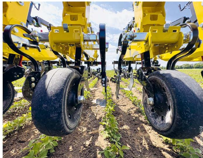
■ Das österreichische Unternehmen APV präsentierte auf der Agritechnica drei neue Maschinen im Bereich der mechanischen Kulturpflege: das Hackgerät HS, die Rollhacke RC und den Rollstriegel RW. Das Hackgerät HS (Hoe Steered) ist mit der Kamerasteuerung laut APV in nahezu allen Reihenkulturen einsetzbar. Die speziell entwickelten Hackshare ermöglichen eine sehr flache Bearbeitung zwischen den Reihen, gleichzeitig werden Beikräuter abgeschnitten und Kulturpflanzen verschont.
