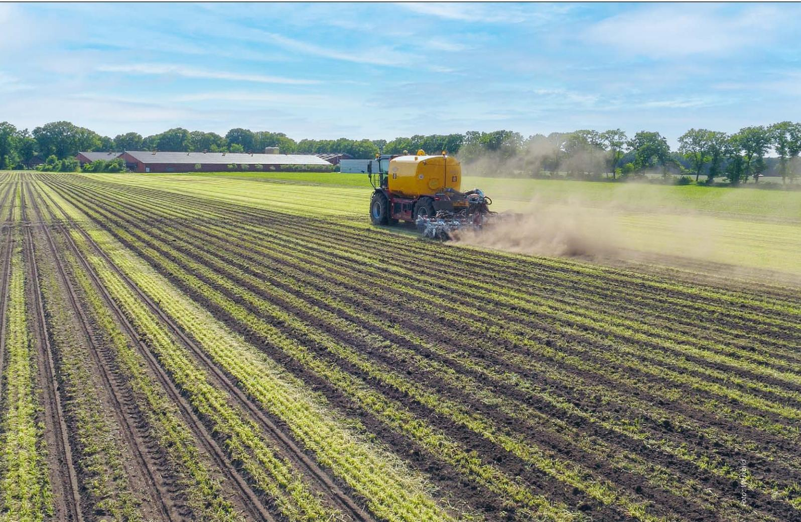
Beim Gülle-StripTill wird nur die Pflanzenreihe bearbeitet. Der organische Dünger wird bandförmig in einer definierten Tiefe abgelegt.
