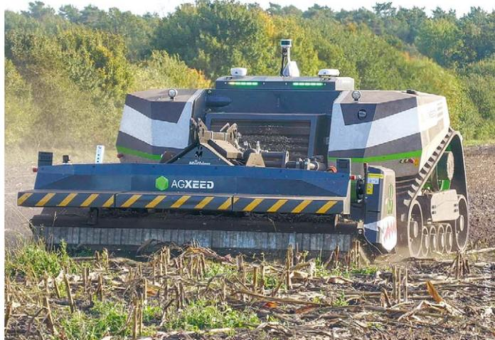
Mit der Entwicklung eines elektrifizierten und sensorüberwachten Mulchers hat Müthing in Kooperation mit AgXeed einen wegweisenden Schritt in Richtung autonomes Ernterestmanagement unternommen. Dieser Mulcher kommuniziert über den ISOBUS nach den Grundsätzen des 3A Verbundes (Advanced Automation & Autonomy) nahtlos mit dem AgBot von AgXeed. Müthing hat einen elektrifizierten Mulcher entwickelt, der mit entsprechender Sensorik ausgestattet ist, um Störungen zu erkennen und
