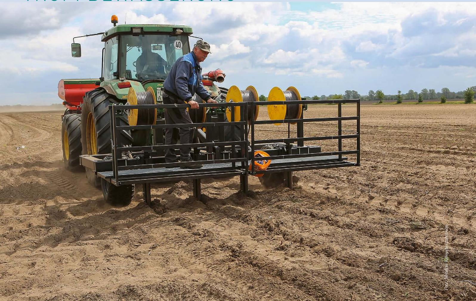
Mechanisierte Verlegung der Tropfschläuche auf 37 cm Tiefe mit einem vierreihigen Gerät
