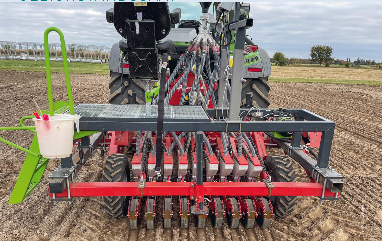
Abb.1: Versuchssämaschine zur maschinellen Gleichstandsaat.
