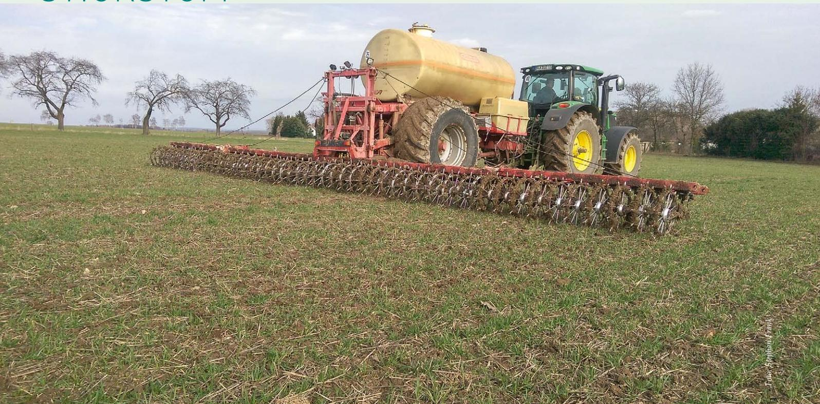
CULTAN-Düngung zu Winterweizen mit einem Igelrad-Injektionsgerät.
