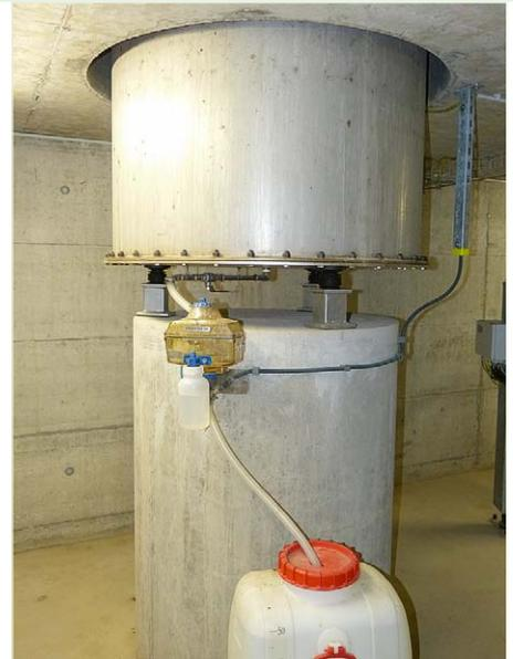
**Abb. 2:** Die Lysimetergefäße stehen auf einem Sockel in einem unterirdischen Raum. Die Messeinrichtungen sind deshalb zugänglich.
